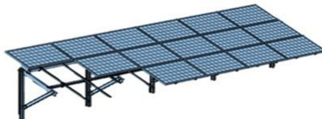
Figura 6: Exemplo de uma estrutura de montagem fixa
