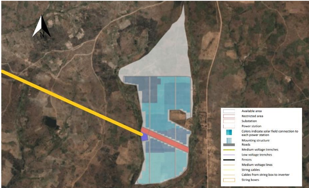
Figura 13: Layout da planta PV (montagem fixa), Chimbunila, Niassa
