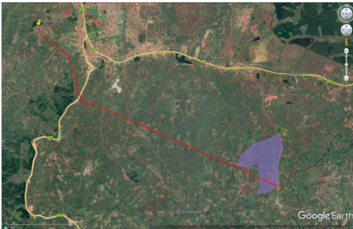
Figura 15: Instalação fotovoltaica e o caminho da linha de transmissão para a subestação de Lichinga
