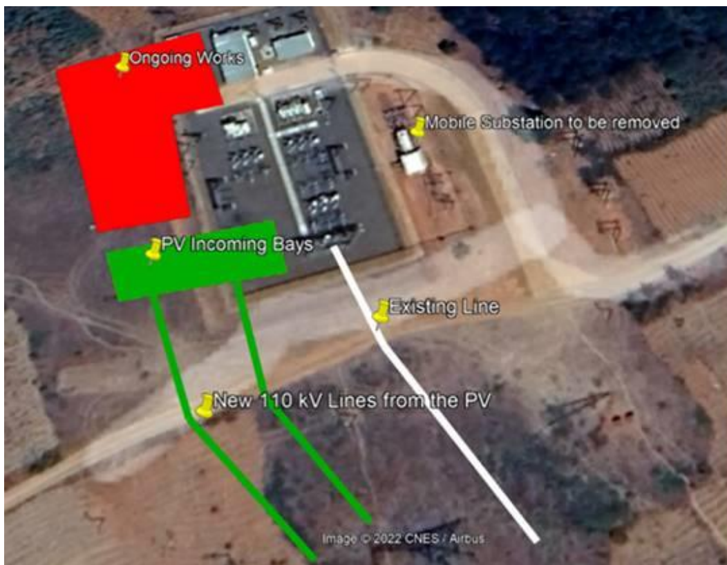
Figura 16: Proposta de ampliação da subestação de Lichinga
