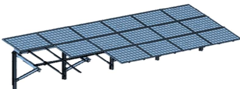
Figura 7: Exemplo de uma estrutura de montagem fixa (3H)
